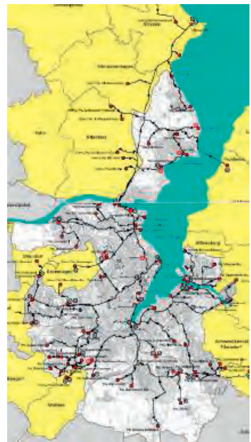
Hauptsammlernetz, Pumpstationen, Messstellen
