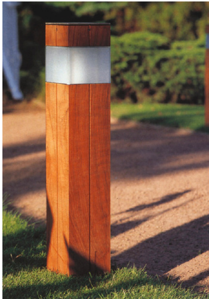
Leuchtentyp: Pollerleuchte Lichtpunkthöhe: 0,8m Leuchtmittel: LED Anschlussleistung: ca. 7W Lichtfarbe: 3000k Lichtverteilung: Asymmetrisch Breit
