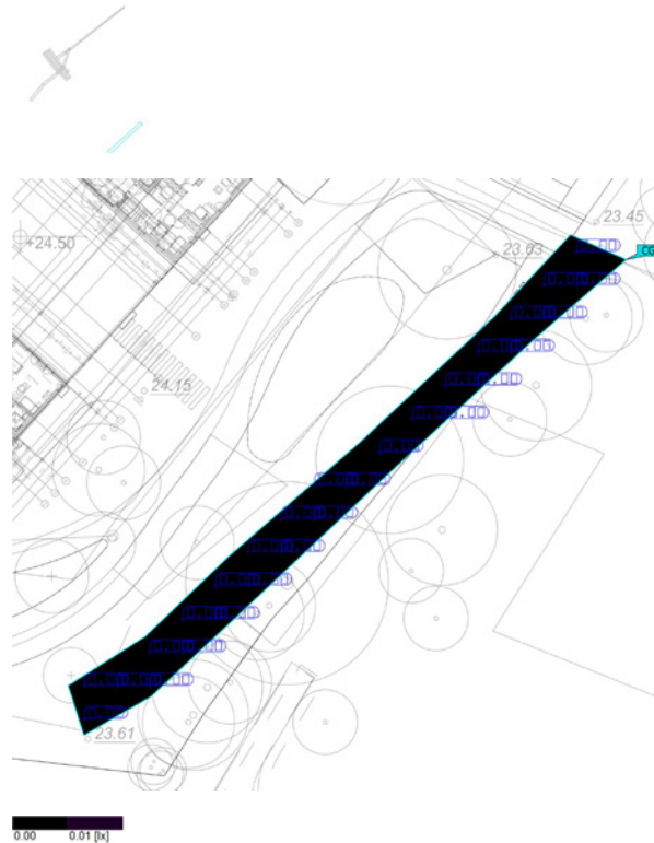
2. Dunkelkorridor - Abschnitt C 2,5m Höhe
