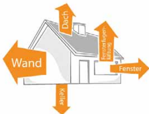
Abb. 1: Wärmeverlust (Transmission und Lüftung) über die Gebäudehülle
