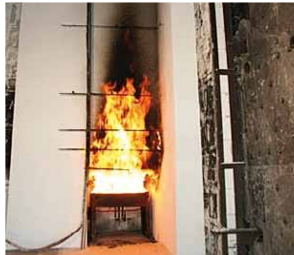
Abb. 11: Fassadenprüfstand gemäß Zulassungsgrundsätzen und Entwurf DIN 4102-20
